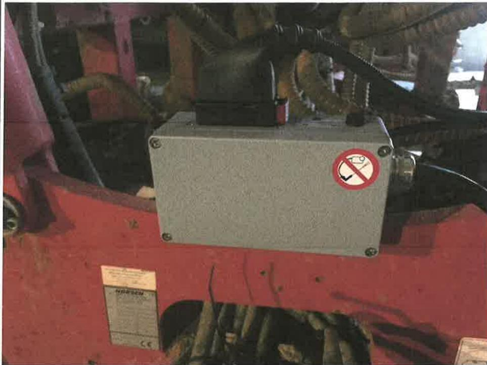
**Abb. Jobrechner zur Tiefensteuerung am Grubber**
