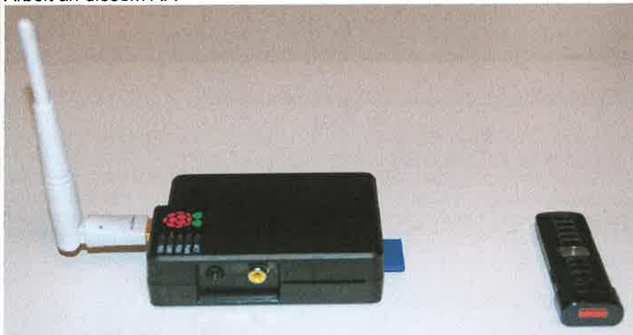
**Abb. Testhardware (links ein Raspberry Pi mit Linux) sowie WLAN-Flash USB Stick**
