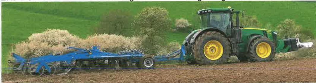
Abb. Testlauf mit angepasstem Grubber von Köckerling und einer Bearbeitungstiefenkarte.
