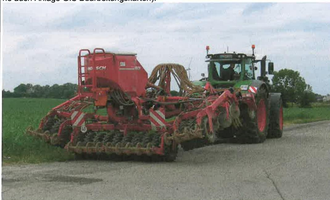
Abb. Praxiskombination tiefengesteuerte Bodenbearbeitung auf dem Weg zum Einsatz
