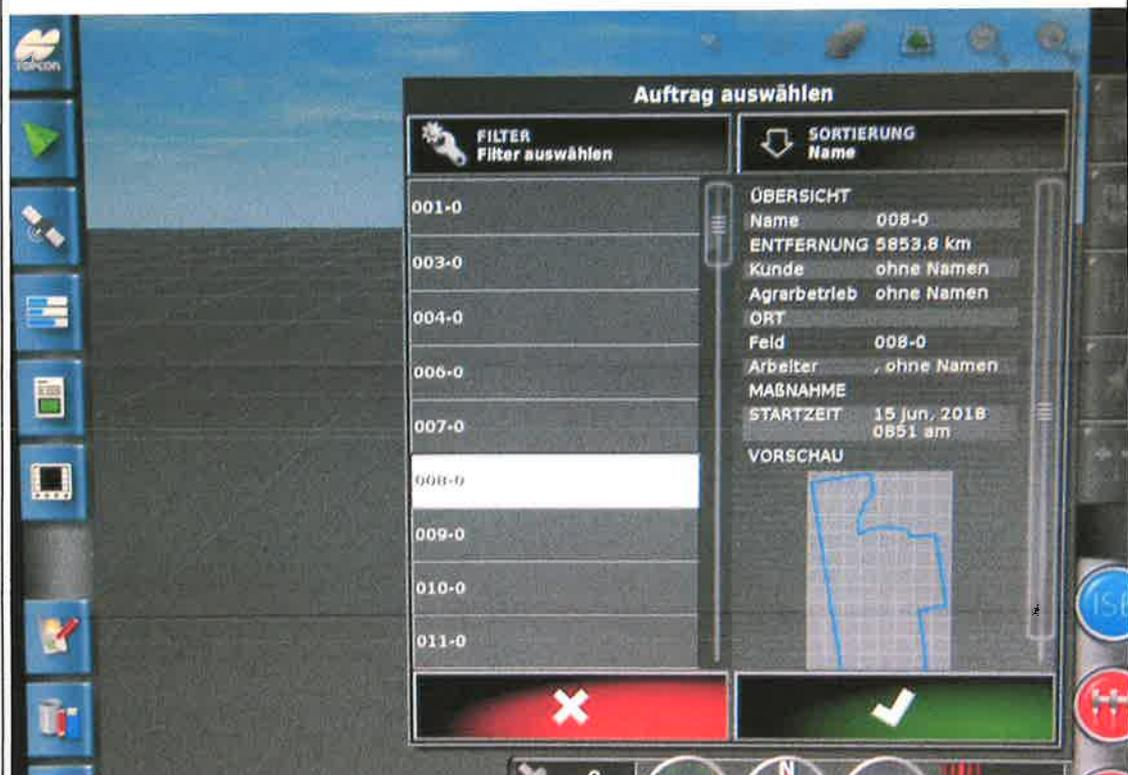
Abb. ISOXML- Auftragsliste auf einem TopCon X30
