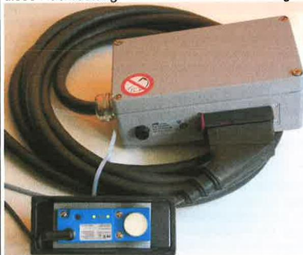
**Abb. Ultraschallsensor und ISOBUS Jobrechner als mögliche Nachrüstlösung für Bodenbearbeitungsgeräte**
